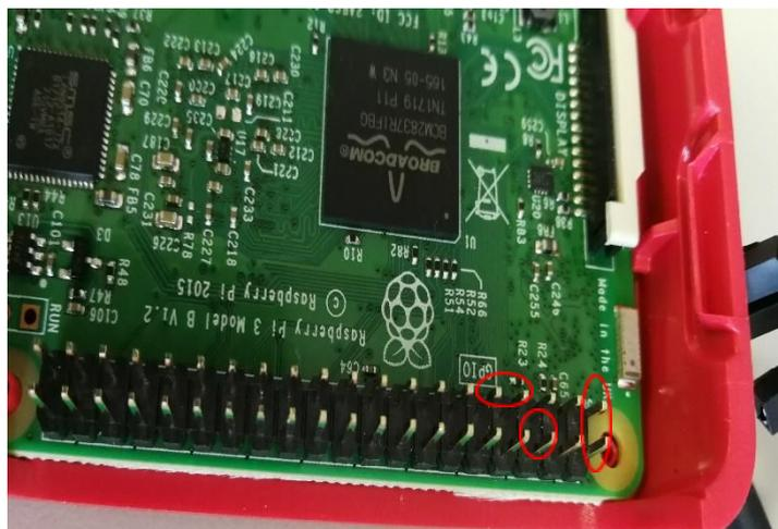
Ci-dessus sont entourés les pins (de gauche à droite et de haut en bas) : 9(GND), 7(GPIO4), 1(3,3V PWR), 6(GND), 2(5V PWR)
